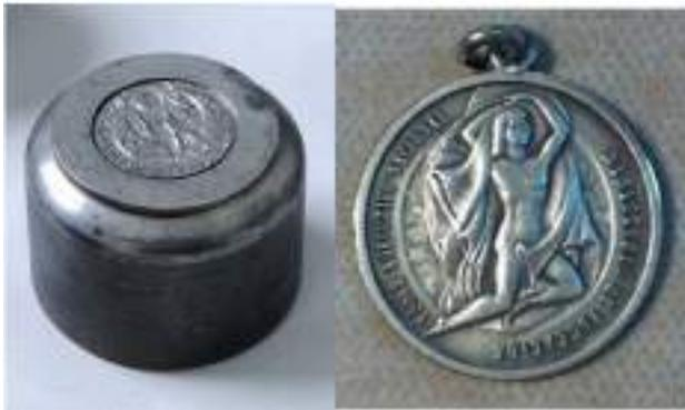
Figura 7. Cuño (molde negativo) y positivo de medalla en plata del diseño 1<sup>8</sup>
