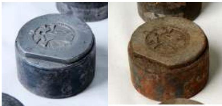
Figura 8. Cuños del diseño 2. Estado de conservación previo y posterior a su intervención<sup>9</sup>
